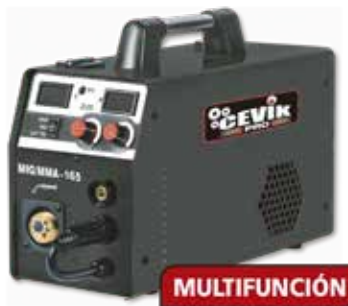
SOLDADURA CE-PROMIG 165 CEVIK Voltaje 230 V. Regulación 20 - 160 A. Potencia absorbida 4,5 Kva. Electrodo 1,6 - 3,4 mm. Protección IP21S. Diámetro hilo (todos) 0,6-1 mm. Peso 6,5 kg.
