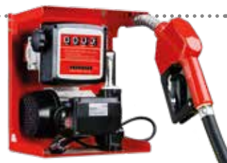
ESTACIÓN MURAL DE TRASVASE CON BOQUEREL AUTOMÁTICO Electrobomba de 60 l/min. Compacta, para su fácil instalación en la pared o sobre un depósito. Para uso propio o industrial. Con contador volumétrico de 4 cifras que permite al usuario verificar el volumen dispensado registrando el consumo parcial y el consumo total. Bomba autoaspirante de paletas con bypass. Con interruptor on/off. Cable eléctrico de 1 m aproximadamente y enchufe.
