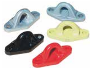
ANCLAJE FIJO ALUMINIO TRAVSAFE Probado para detener la caída de 2 usuarios, 150kg. Incluye indicador de caída. Cumple con la norma EN795 - A: 2012. Fijación mediante 2 anclajes M12.
