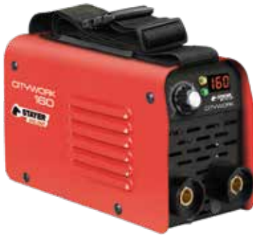
INVERTER CITYWORK 160 K STAYER Corriente: 160 A. Voltaje: 230 V. Generador: 2-4 KVA. Factor de marcha 100%. Max. electrodo: 4 mm. Peso 2,7 kg. Borna 3/8" (10-25).
