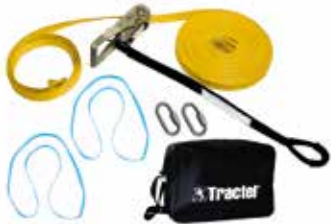
LÍNEA DE VIDA PARA 2 PERSONAS TRAVSAFE TEMPO™ De cinta para dos personas con un peso de 150 kg. Longitud máxima 20 m. Incluye 2 conectores MR9, 2 cintas de anclaje AS30S y bolsa bandolera. Norma EN 795-B: 2012.
