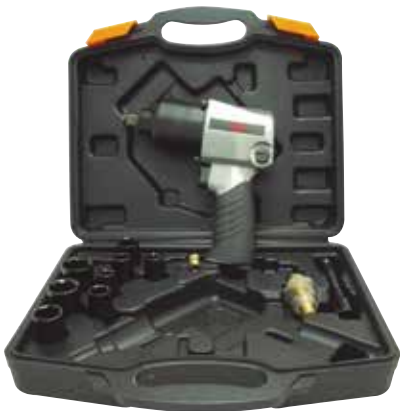
LLAVE DE IMPACTO 1/2 CON VASOS Sistema de impacto doble maza. Capacidad M-18. Apriete hasta 680 Nm. Salida de aire inferior. Velocidad 7.000 rpm. Gama de uso Continuada. Incluye 8 vasos de impacto 10, 11, 13, 14, 17, 19, 22, 24. Una alargadera 125 mm y un miniengrasador.
