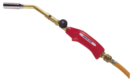
SOPELETE AIRPROP SUPER EGO Soldadura blanda y dura y trabajo por calentamiento. Conexión roscada al depósito de gas (R3/81"L) en manguera de alta presión de 2 m. Se usa con gas butano y propano.
