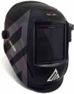
PANTALLA DE SOLDAR HELLMET R-10XL SOLTER Tecnología TRUE COLOR, 4 sensores. Máxima calidad óptica (1/1/1/1). Gran campo de visión (100 x 100mm). Regulable DIN 5-8 y 9-13, sensibilidad y retardo. Válida para MMA, MIG/MAG y TIG. Pila reemplazable.
