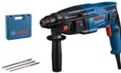
MARTILLO PLUS GBH 2-21 PROFESSIONAL BOSCH 720 W, 2,0 J. SDS-plus. Perforación hasta 21 mm. Control electrónico. Giro reversible. Velocidad variable. Parada de giro para cincelar. 2,5 Kg. Set brocas 3 unidades (6/8/10mm). Maletín.
