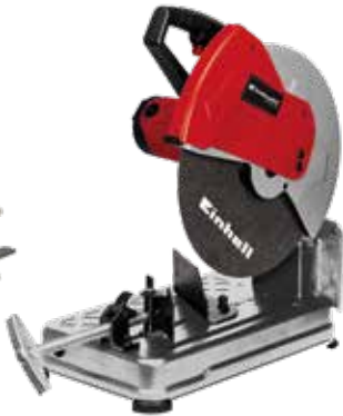
TRONZADORA TC-MC 355 Potencia 2300 W, rpm 4.000, diámetro disco 355 mm. Ø25,4. Arranque lento, protección sobrecarga, garra para asegurar las piezas. Tamaño máximo de corte en piezas circulares: 100 mm, en piezas rectangulares: 70 x 170 mm. Sujeción para piezas.
