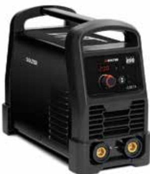
INVERTER DIRT 200 CEVIK Nueva tecnología "Arc-sense", permitiendo soldar cualquier tipo de electrodo. Incluido el de aluminio. Intensidad de soldadura 200 A. Rendimiento: 40% a 40°C. Válida para generador. Peso: 6 kg.
