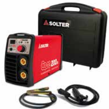
INVERTER CORE 200DI SOLTER Nueva tecnología "Nanocrystalline". Intensidad de soldadura 200 A. Rendimiento: 60 % a 40°C. Válida para generador. Electrodo utilizables MMA: 1,6mm - 4,0mm. Se suministra accesorios de soldadura y maletín. Cumple la norma EN-60974.
