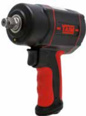
LLAVE DE IMPACTO DE 1/2" COMPOSITE YAIM Sistema de impacto doble maza. Capacidad M-18. Apriete hasta 850 Nm. Salida de aire inferior. 8.500 rpm. Gama de uso profesional.
