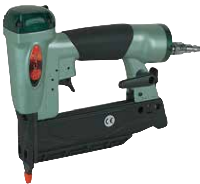
CLAVADORA NOVA 8/45 UNICAIR Clavadora de 0,8 mm con y sin cabeza. De 15 a 30 mm sin cabeza y 15 mm a 45 mm con cabeza. Fijación de molduras y marcos, tapa-juntas, decoración en muebles, etc.
