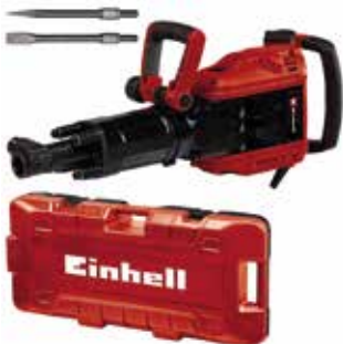
MARTILLO DEMOLEDOR TP-DH 50 EINHELL Potencia 1700 W. Impactos por minuto 1900 min -1 . Potencia de impacto 50 J. Portabrocas SDS-hex. Mango ajustable adicional para una mayor comodidad cuando se trabaja. Cable de goma extralargo y robusto. Incluye cincel puntiagudo y plano. Entregado en un práctico estuche de transporte y almacenamiento E-Box L90.
