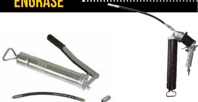
BOMBA ENGR. NEUMÁTICA CONTINUA FAHERMA 500 cc. Pistola para conectar a una línea de aire comprimido, compresor o calderín de un camión. Embolo de empuje adecuado para llenado por succión, con cartucho o granel.
