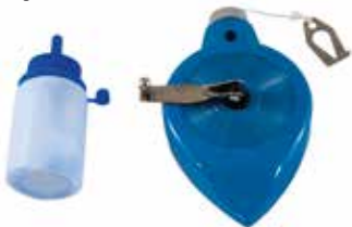
TIRALÍNEAS ALUM + AZULETE 50 G Tiralíneas recargable de hilo: cuerpo de aluminio fundido a presión, hilo de algodón longitud 25 m; manivela para rebobinar y boquear el hilo; gancho de sujeción hilo. Con el tiralíneas se suministra también un bidón de polvo azul de 50 gr.
