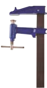
APRIETOS PIHER F De émbolo. Cabeza fundición. Llantá acero laminado. Freno antideslizante. Alcance 12 cm. Llantá 35 mm x 8 m. Aberturas 40, 60, 80 y 100 cm.
