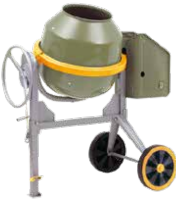
HORMIGONERA UL-155 PLUS UMACON Hormigonera reforzada plegable, bastidor desmontable y reductor de volteo, 0,5 HP. 68 kg. 1,9 m³/hora de rendimiento. 130 l de mezcla. Motor monofásico.
