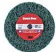
El disco Scotch-Brite™ Roloc™+ Clean and Strip XT Pro Extra Cut cuenta con un mineral abrasivo de óxido de aluminio incorporado en una malla de nylon abierta. Nuestros discos están diseñados para eliminar revestimientos duros, como capas gruesas de óxido o pintura, y corrosión, al mismo tiempo que homogeneizan y refinan el metal a la vista subyacente.
